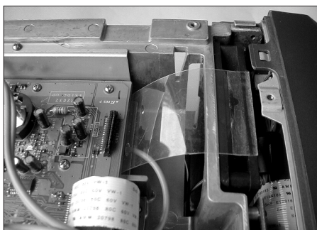
Der Luftstrom vom Lüfter (rechts) wird mit einer Folie umgeleitet
